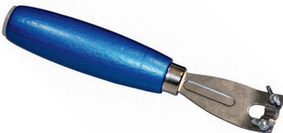
Применяется для разделки шва в мягких ПВХ-покрытиях. Форма лезвия позволяет постоянно выбирать требуемую глубину.
